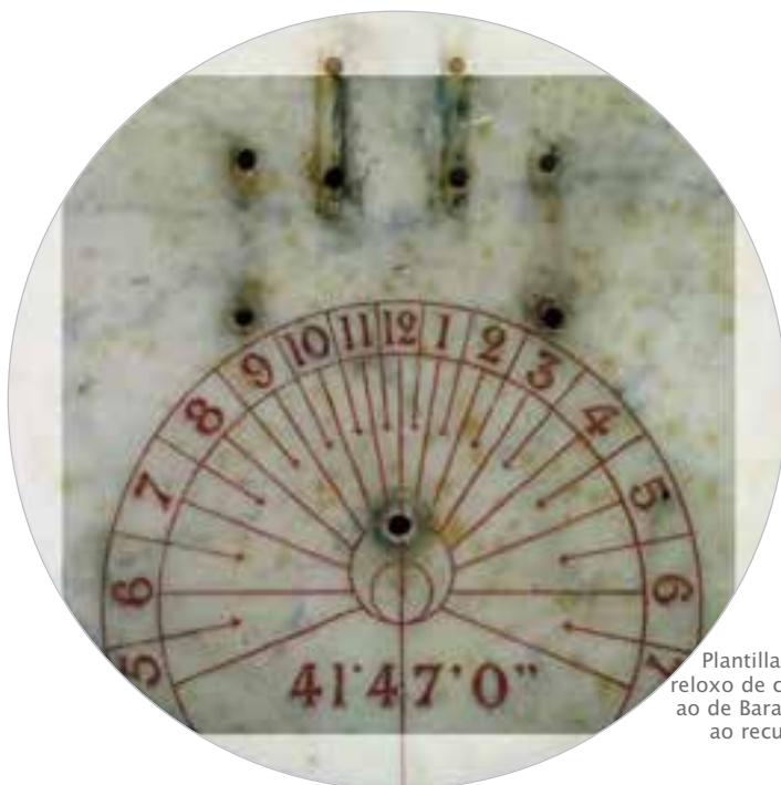
Peza de mármore da base primitiva do reloxo cas perforacions do canón meridiano
