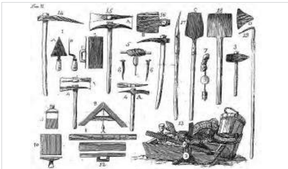
As ferramentas e utensilios empregados polos canteiros e albaneis no s. XVIII eran: 1) Paleta, 2) Trollo, 3) Pico, 4) Piquetiña, 5) Corda, 6) Cravos, 7) Chumbada, 8) Regra, 9) Nivel, 10) Esparabel, 11) Fratás, 12) Talocha, 13) Cubos, esportas, liás, 14) Piqueta, 15) Zapapico, 16) Sacho, 17) Pa de ferro, 18) Pa de madeira, 19) Batideira 9 .
