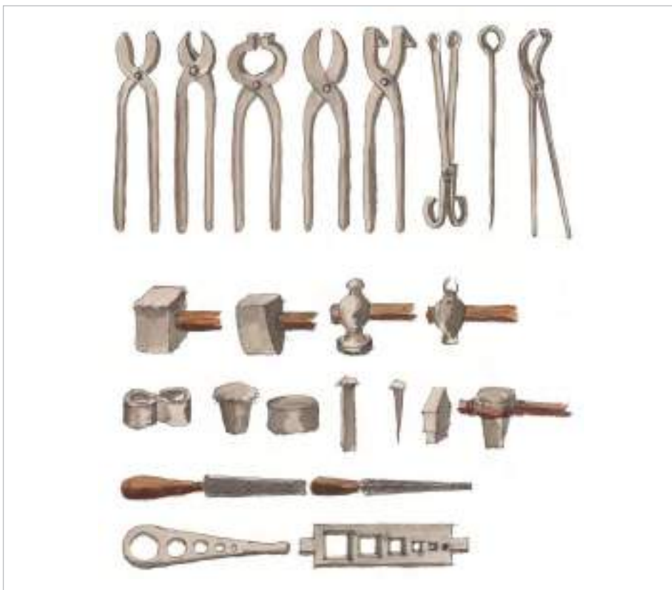
Ferramentas dos ferreiros: 1, 2, 3, tenaces, 4, tenaces de corte, 5, tenaces de volta, 6, tenaces de lume, 7, atizador, 8, tenaces curvas, 9, esteixador, 10, 11, 12, martelos, 13, sufrideira, 14,15, tufos, 16, tronzafrio, 17, punzón, 18,19, tallesiras, 20,21, limas, 22,23, tallesiras.
