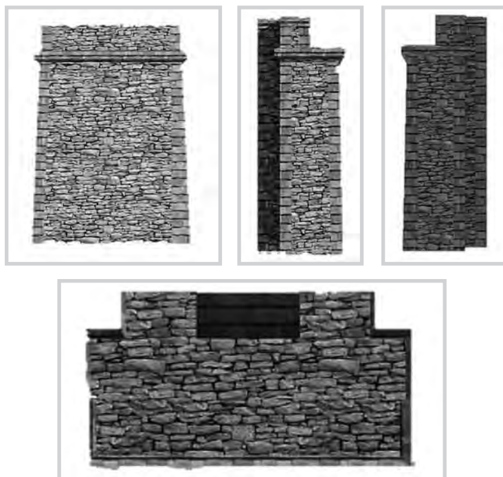
Figura 16: Alzado, perfis e planta do estribo direito
