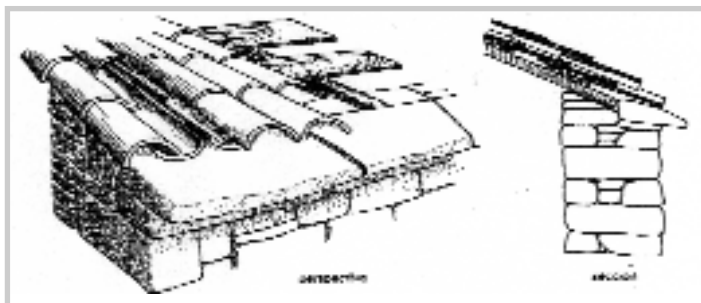
Esquema tradicional do sistema de cuberta a base de tella do país. (Tomado de LLANO, 1989: 71)
