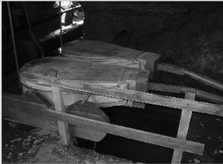
Fotografía de dous foles ou barquíns accionados por medio da forza motriz da auga.
