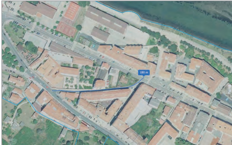
Ilustración 26. Tramo de renovación de tubaxe xeral de fibrocemento.
