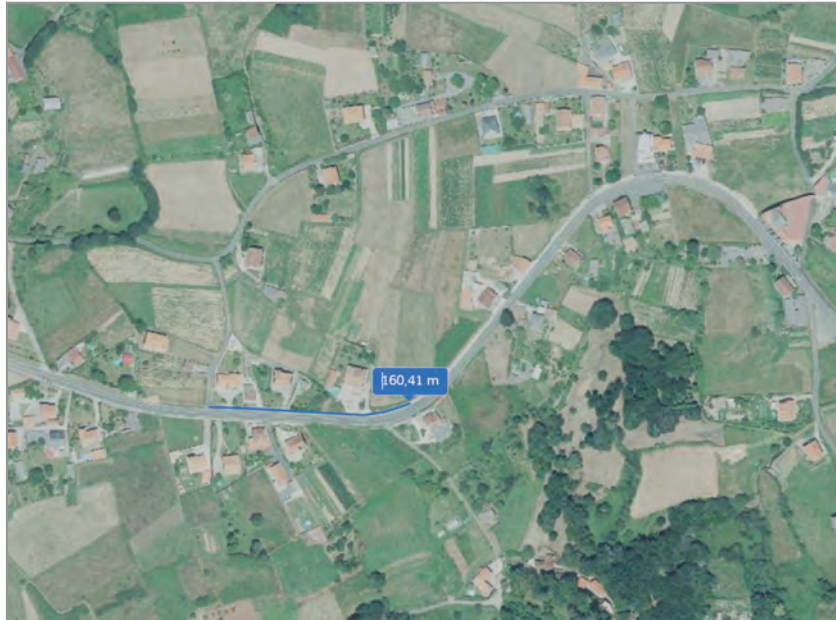
Ilustración 25. Tramo de renovación de tubaxe xeral de fibrocemento.
