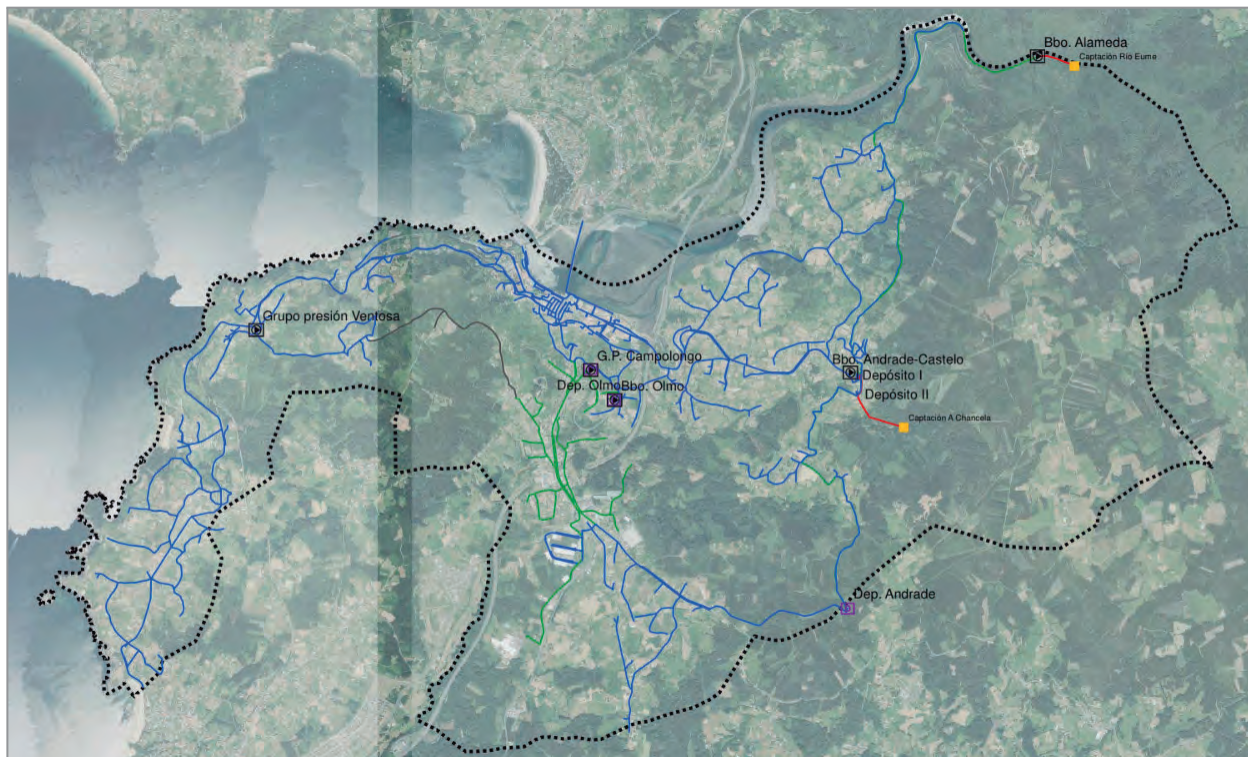
Ilustración 2. Sistema de Abastecemento do Municipio de Pontedeume.
